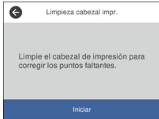
6. Seleccione **Iniciar** para limpiar el cabezal de impresión.
