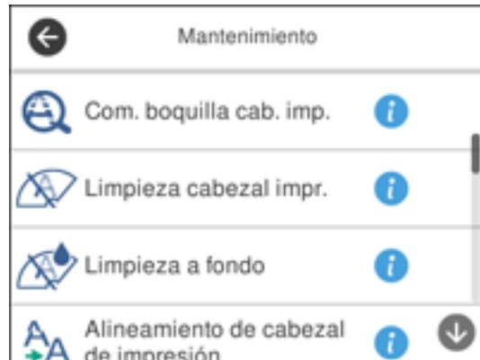
5. Seleccione **Alineamiento de cabezal de impresión**.
